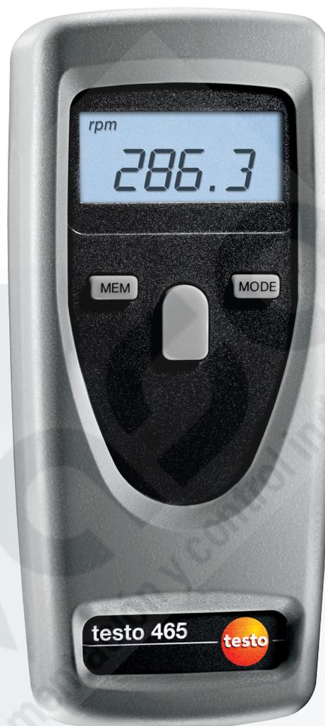
Con el testo 465 se miden las rpm sin contacto usando una sola mano. Este tacómetro está pensado para medir especialmente en piezas giratorias como ventiladores o ejes. Solo hay que pegar una cinta reflectante (opcional) en el objeto a medir, apuntar el haz de luz roja a la cinta y leer los valores. Este tacómetro puede medir en distancias
