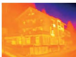
Imagen térmica sin testo ScaleAssist
