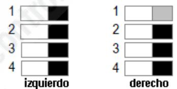
Posición para configuración con LCC-S
