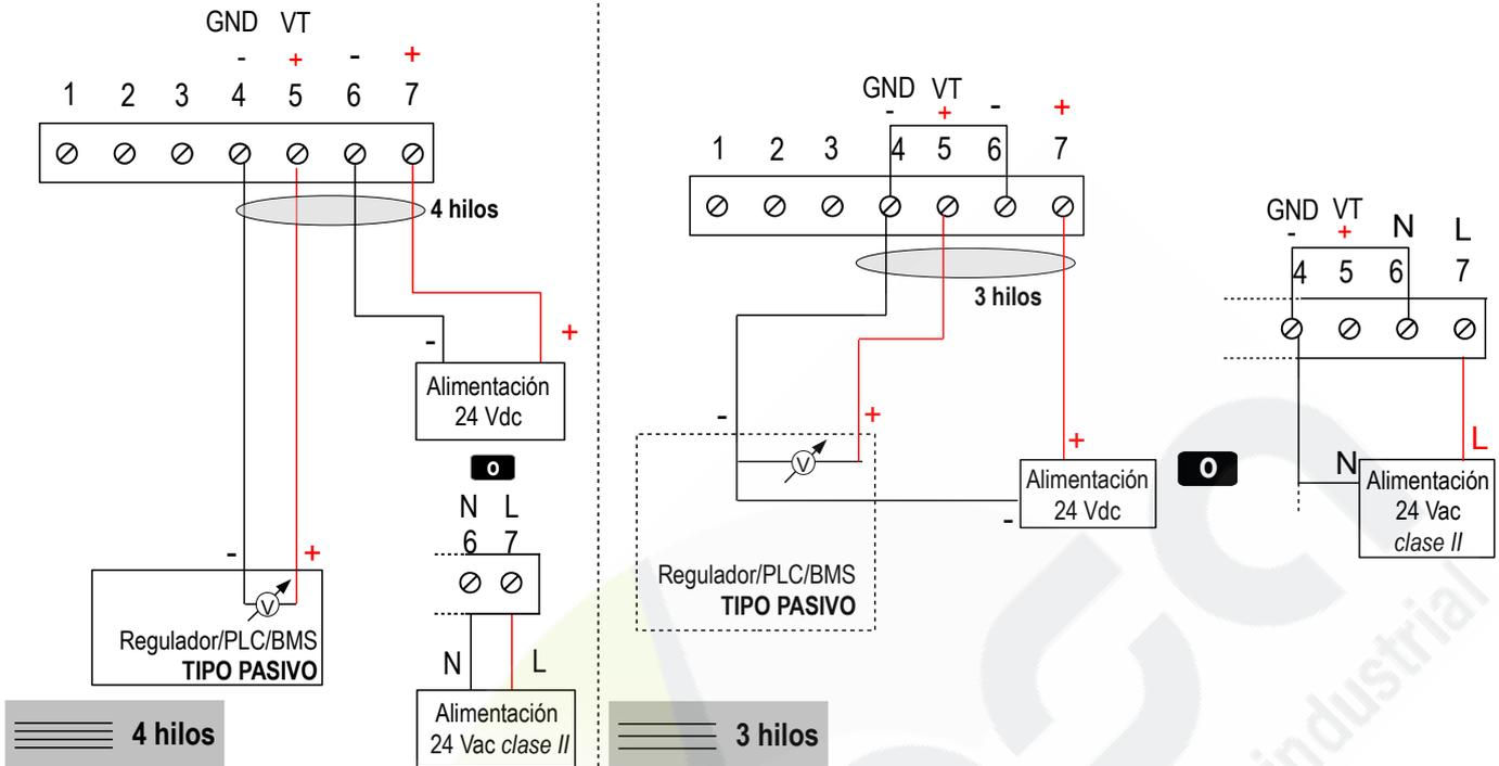
Para modelos **TM110-PO** y **TM110-PN** con salida **4-20 mA - lazo pasivo** :
