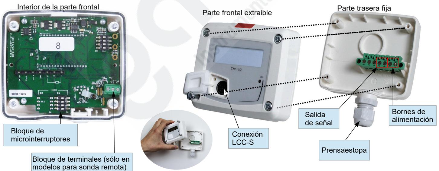
Conexión de una sonda Pt100 al bloque de terminales
