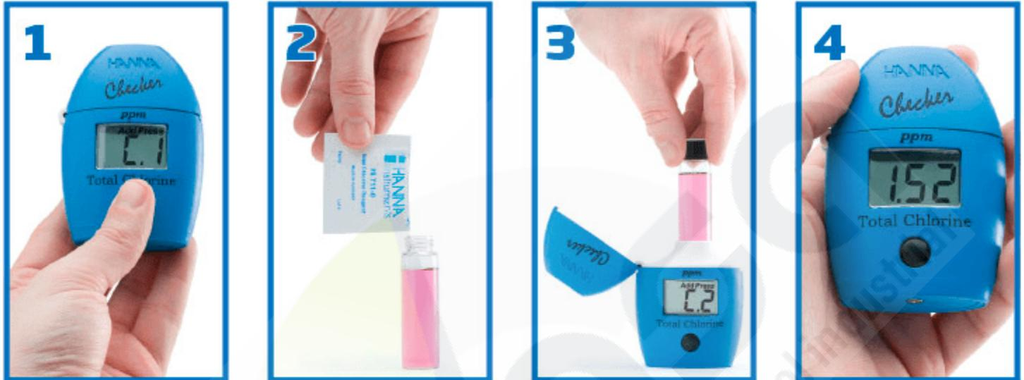
**1** "Zero" el Checker<sup>®</sup> HC según lo requiera el procedimiento específico.
