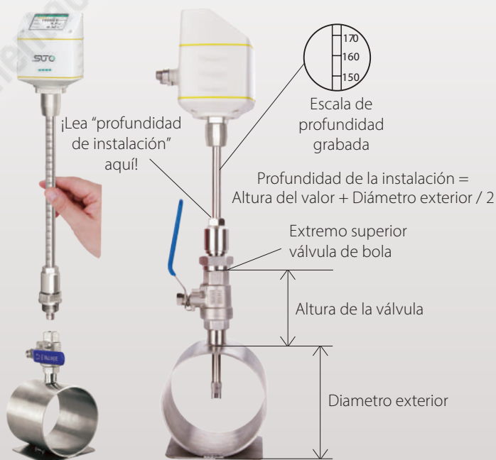
S430 Instalación a través de una válvula de bola
