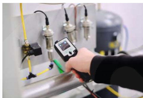
Detector de fugas ultrasónico S530
