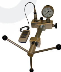
Variante 4: Maletín de calibración con un máximo de 5 sensores de presión, incl. bomba de husillo manual
