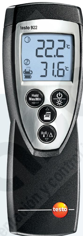
El testo 922 es un termómetro ideal para las aplicaciones típicas del sector HVAC. El medidor registra los valores de dos sondas de termopar conectadas y las muestra simultáneamente junto a la temperatura diferencial en el visualizador. La transmisión de datos de medición por radio permite visualizar la lectura de otro sensor de temperatura. El instrumento con la funda protectora TopSafe y las sondas conectadas cuenta con la protección IP 65.
