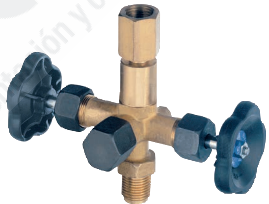
Válvula de cierre con conexión de prueba según DIN 16272 con cierre separado, racor de sujeción hembra/macho G 1/2, con espiga de prueba M20 x 1,5, PN 400
