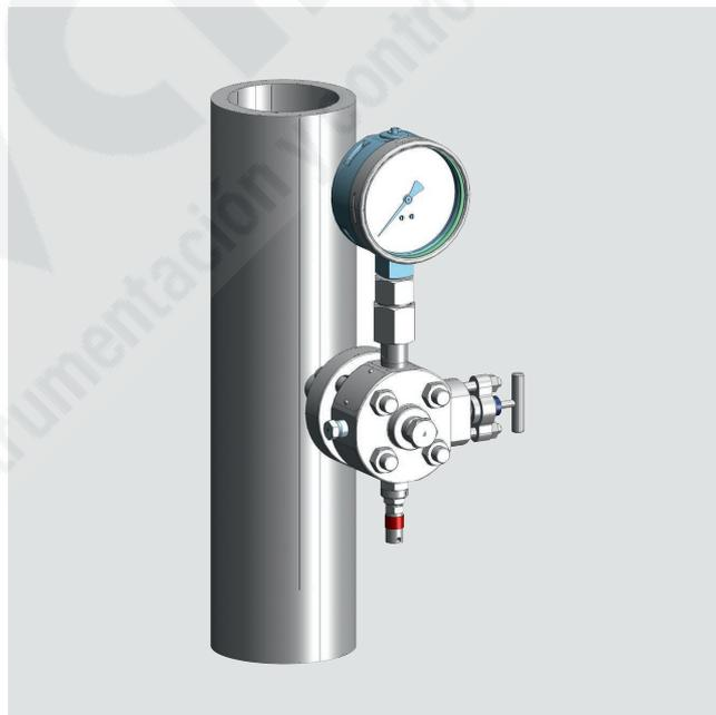
Las monobridas de dispositivos se instalan detrás de una primera válvula de cierre, como se muestra en la ilustración. Las monobridas de proceso están diseñadas con un bonete de válvula OS&Y para el bloqueo del lado de proceso. El generoso diseño de la geometría de paso del bonete de la válvula OS&Y evita la obstrucción por acumulación de partículas. Con el uso de monobridas de proceso se puede prescindir de válvulas de bloqueo convencionales.
