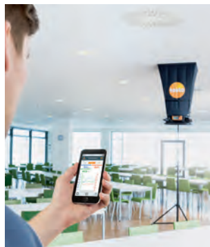
Conexión a la aplicación por medio de Bluetooth para visualizar los datos medidos en los dispositivos móviles y elaborar un informe desde el lugar de la medición.
